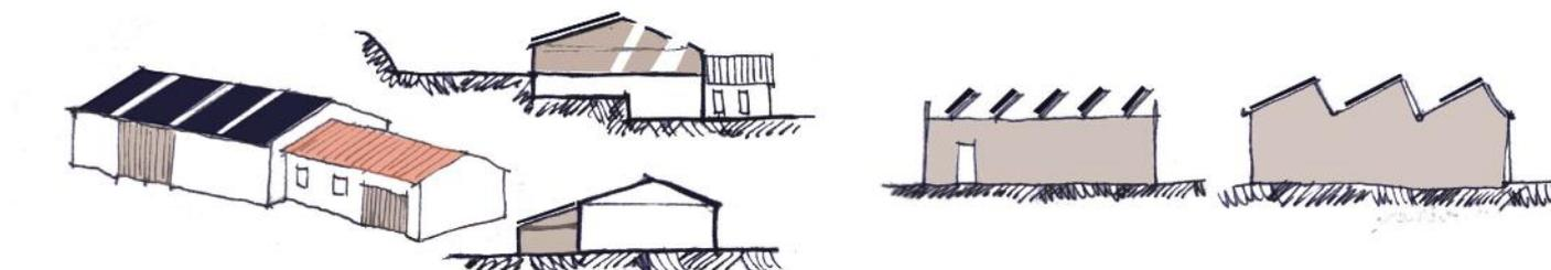
Exemples d'insertion des panneaux sur des bâtiments de grandes dimensions ou sur des équipements.
